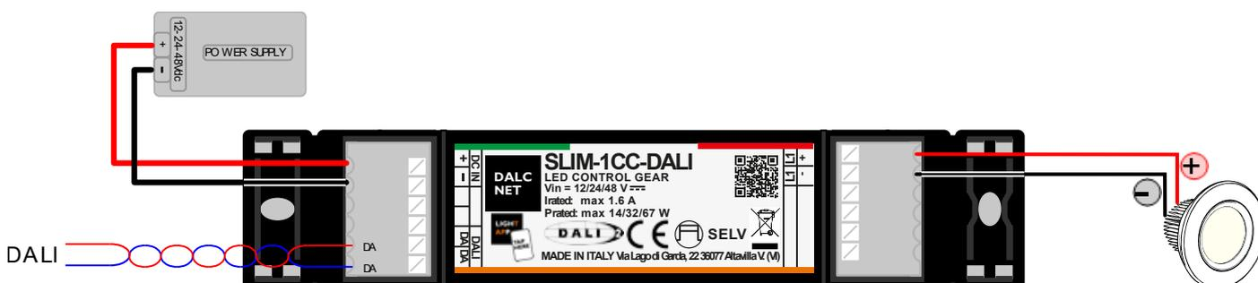
Figura 2: Schema di collegamento per carichi LED bianchi o monocoloro
